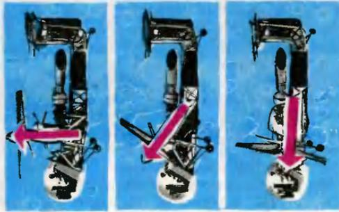
летному, а затем развернутся в самолетное положение. Однако до сих пор конструкция полноротного крыла сложилась черезур сложной и громоздкой. И вот недавно это затруднение, казалось, удалось преодолеть американским конструкторам. Экспериментальный летательный аппарат «Белл ХУ-15» с турбовинтовыми двигателями уже совершил несколько экспериментальных полетов.
